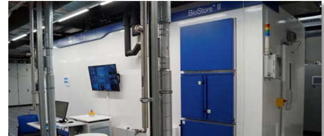
Probenlagerung bei -80°C im automatisierten Lagerroboter
